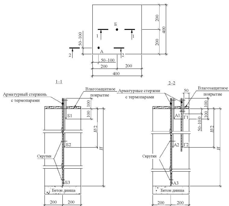
$H$  – высота колонн; А, Б – местоположение точек замера температуры на плане; А<sub>1</sub>, А<sub>2</sub>, А<sub>3</sub>, Б<sub>1</sub>, Б<sub>2</sub>, Б<sub>3</sub>, Г<sub>1</sub>, Г<sub>2</sub> – соответственно местоположение точек замера температуры по высоте колонн
