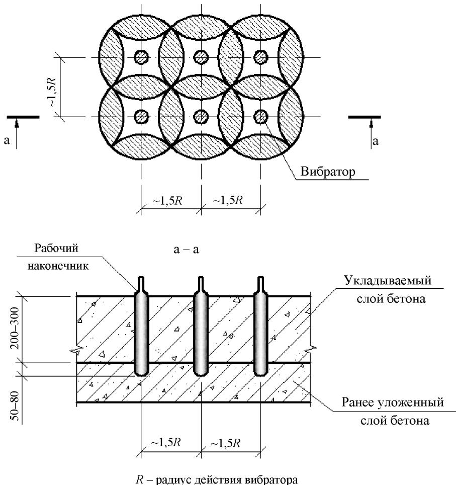
**Рисунок 9.4 – Схема уплотнения бетонной смеси глубинными вибраторами**
