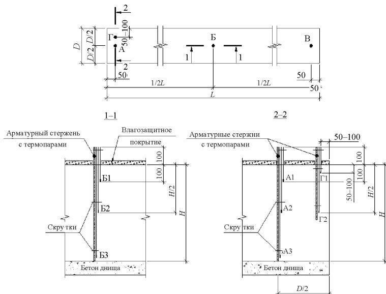
$D$  – ширина балок;  $H$  – высота стен; А, Б, В, Г – местоположение точек замера температуры (термодатчиков) на плане (сверху); А<sub>1</sub>, А<sub>2</sub>, А<sub>3</sub>, Б<sub>1</sub>, Б<sub>2</sub>, Б<sub>3</sub>, Г<sub>1</sub>, Г<sub>2</sub> – соответственно местоположение точек замера температуры в разрезе (по высоте)
