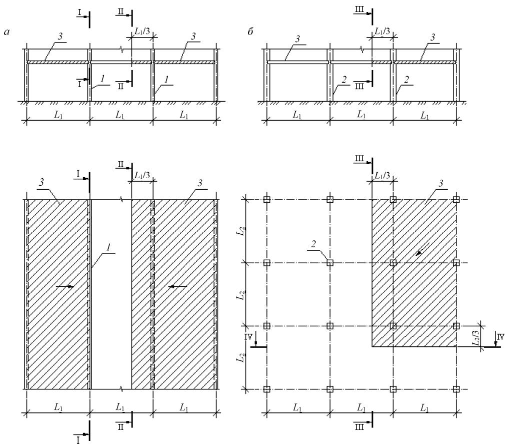
а – опирающиеся на стены; б – опирающиеся на колонны; I–IV – места устройства рабочих швов; 1 – стена; 2 – колонна; 3 – перекрытие;  $L_1$  и  $L_2$  – соответственно расстояния между продольными и поперечными координационными осями
