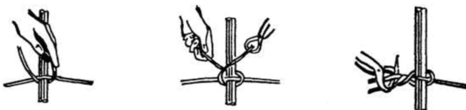
Рисунок 7.2 – Вязка угловых узлов с подтягиванием
