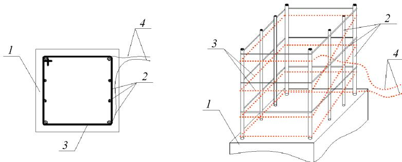
1 – фундамент; 2 – арматура; 3 – греющий провод; 4 – выпуски греющего провода для подключения к питательным электрическим проводам (места подключения должны находиться в бетоне)
