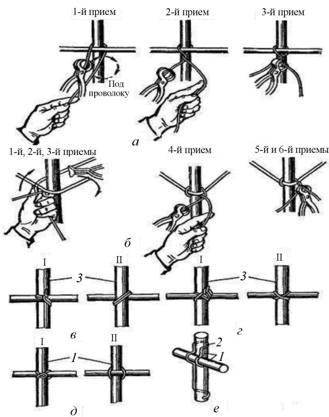
а – вязка проволокой в пучках без подтягивания; б – вязка угловых узлов; в – двухрядный узел; г – крестовый узел; д – мертвый узел; е – скрепление стержней соединительным элементом; I – вид узла спереди; II – вид узла сзади; 1, 3 – стержни; 2 – соединительный элемент;
