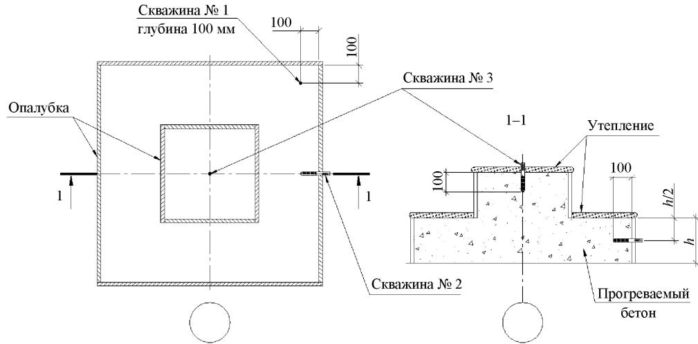
**Рисунок 10.6 – Схема расстановки температурных скважин в отдельном фундаменте**
