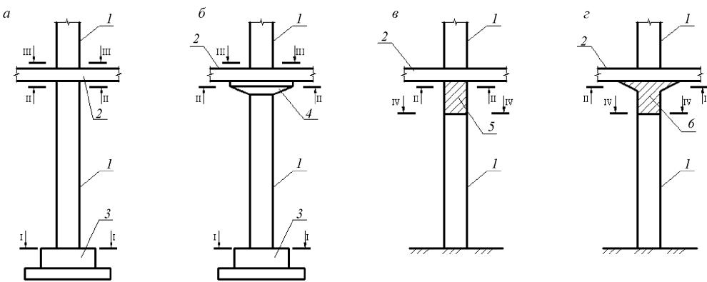
I–IV – места устройства рабочих швов; 1 – колонна; 2 – плита перекрытия; 3 – фундамент; 4 – капитель; 5 – балка; 6 – балка с вутами
