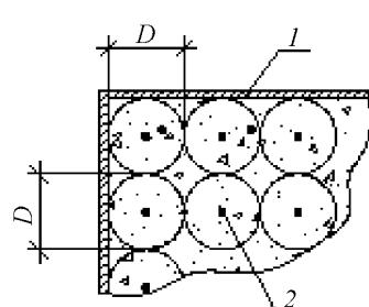
1 – опалубка; 2 – вибратор; S – расстояние между точками погружения вибратора;
