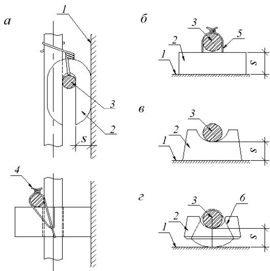
a, б, в – с большой поверхностью контакта с опалубкой, изготовленные из цементно-песчаного раствора; г – с малой поверхностью контакта с опалубкой, изготовленный из цементно-песчаного раствора; 1 – рабочая поверхность опалубки; 2 – фиксатор; 3 – фиксируемая арматура; 4 – скрутка из вязальной проволоки; 5 – вязальная проволока, заделанная в фиксатор; 6 – эластичное кольцо; s – нормируемая величина защитного слоя
