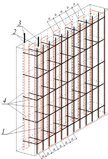
1 – греющий провод; 2 – соединение греющего провода с коммутационным; 3 – коммутационные провода;
