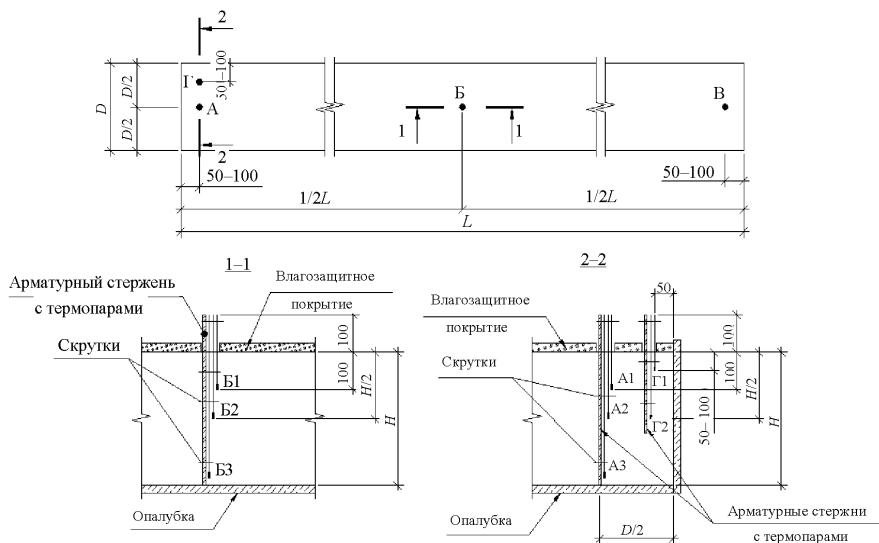
$D$  – ширина балок;  $H$  – высота балок;  $L$  – длина балок; А, Б, В – местоположение точек замера температуры на плане (сверху); А<sub>1</sub>, А<sub>2</sub>, А<sub>3</sub>, Б<sub>1</sub>, Б<sub>2</sub>, Б<sub>3</sub>, Г<sub>1</sub>, Г<sub>2</sub> – соответственно местоположение точек замера температуры в разрезе (по высоте)
