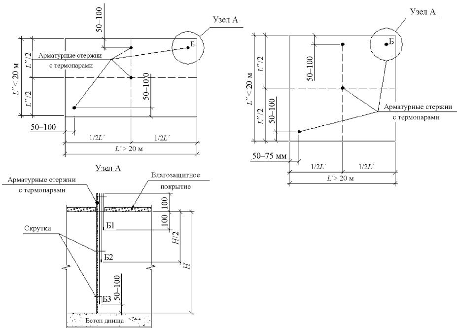
$H$  – высота плиты;  $L'$  – длина фундаментной плиты;  $L''$  – ширина фундаментной плиты; Б – местоположение точек замера температуры (термодатчиков) на плане (сверху); Б<sub>1</sub>, Б<sub>2</sub>, Б<sub>3</sub> – соответственно местоположение точек замера температуры в разрезе (по высоте)
